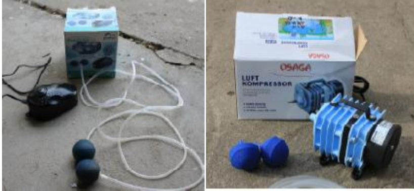
Bild Nr. 6: Aquariumpumpe und Teichbelüfter
